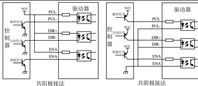
图 3(b) 单端方式控制信号接口接线图
