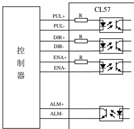
图 3(a) 差分方式控制信号接口接线图
