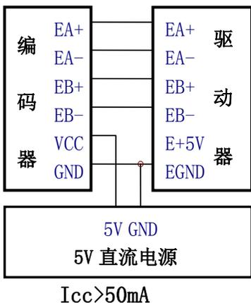
图 5 编码器外加电源供电时接线图
