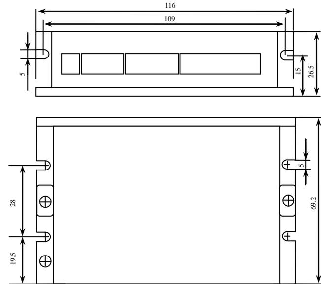
图 1 机械安装尺寸图(单位:mm)
